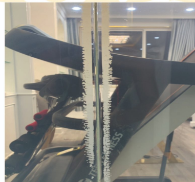
Kính điện bị keo axit ăn mòn
